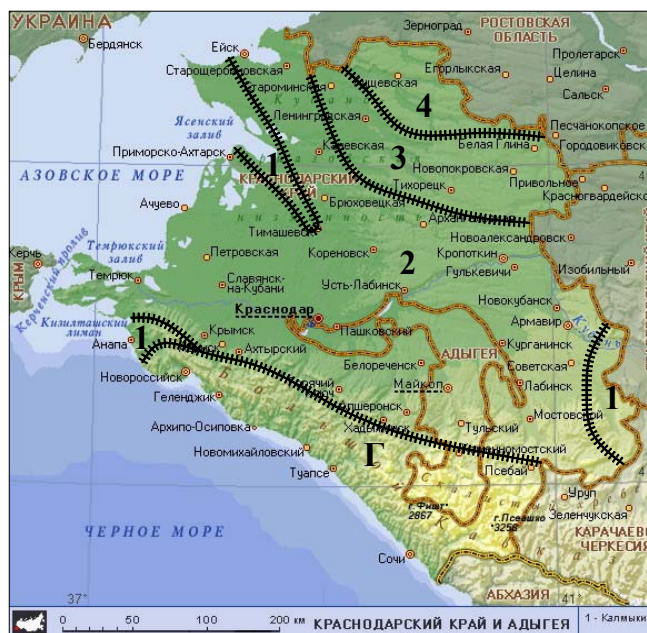
Рисунок 4 – Схема районирования для дорог III технической категории в пересеченной местности и дорог IV и V технической категории в равнинной местности
