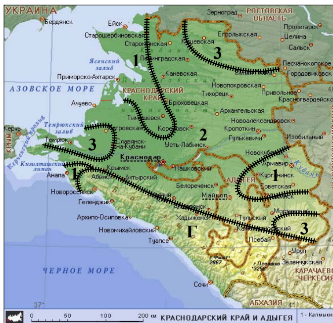
Рисунок 2 – Схема районирования территории Краснодарского края по величине минимально допустимых радиусов кривых в плане для дорог II технической категории в равнинной местности
