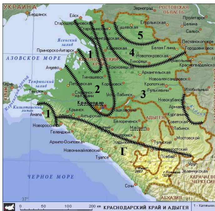
Рисунок 3 – Схема районирования для дорог II технической категории в пересеченной местности и дорог III технической категории в равнинной местности
