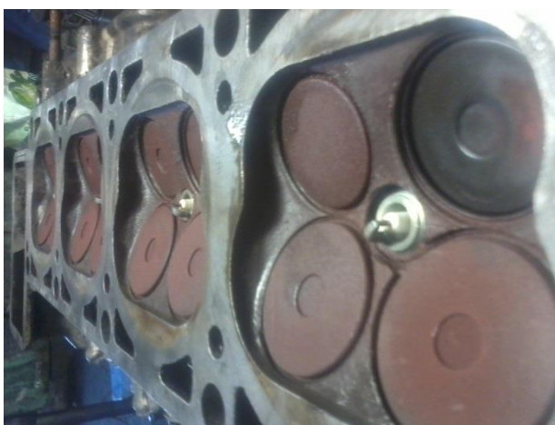
Рисунок 2 – «Проседание» выпускных клапанов ГБЦ двигателя ЗМЗ-406.1
