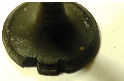
Рисунок 5 – Прогар тарелки клапана как следствие износа пары седло – клапан.
