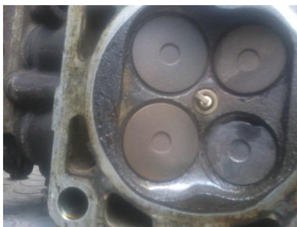
Рисунок 3 – Прогар клапана, как следствие «проседания» седла ГБЦ ЗМЗ 406.1
