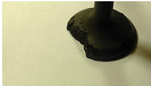
Рисунок 5 – Прогар тарелки клапана как следствие износа пары седло – клапан.
