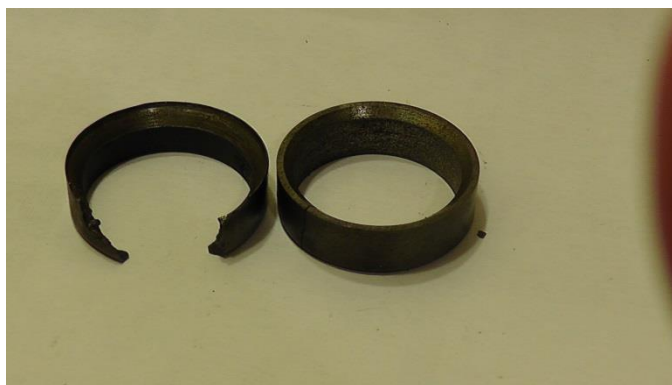
Рисунок 4 – Седло слева – демонтировано при текущем ремонте ГБЦ, седло справа – новое
