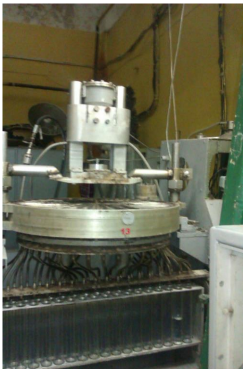
Рисунок 2 – Проливочный стенд для испытания деталей с газовыми каналами
