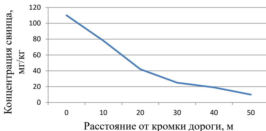
Рисунок 4 – Пример аппроксимации экспериментальных данных экспоненциальной зависимостью для концентраций свинца около дороги (М-6 «Каспий»)
