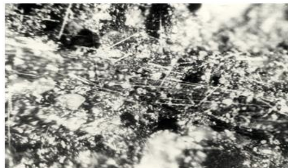
Рисунок 2 – Микрофотография структуры поперечного сечения хаотически армированного СВПБ (черные пятна на фотографии – воздушные поры различной формы), \times 640
