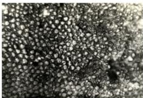
Рисунок 1 – Микрофотография структуры поперечного сечения ориентированного стекловолокнистого полимербетона (схожесть со структурой аналогичных
