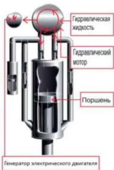
Рисунок 3 – Схема конструкции амортизатора
