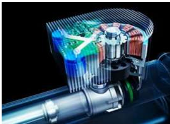
Рисунок 23 – Схема активной подвески с рекуперацией энергии
