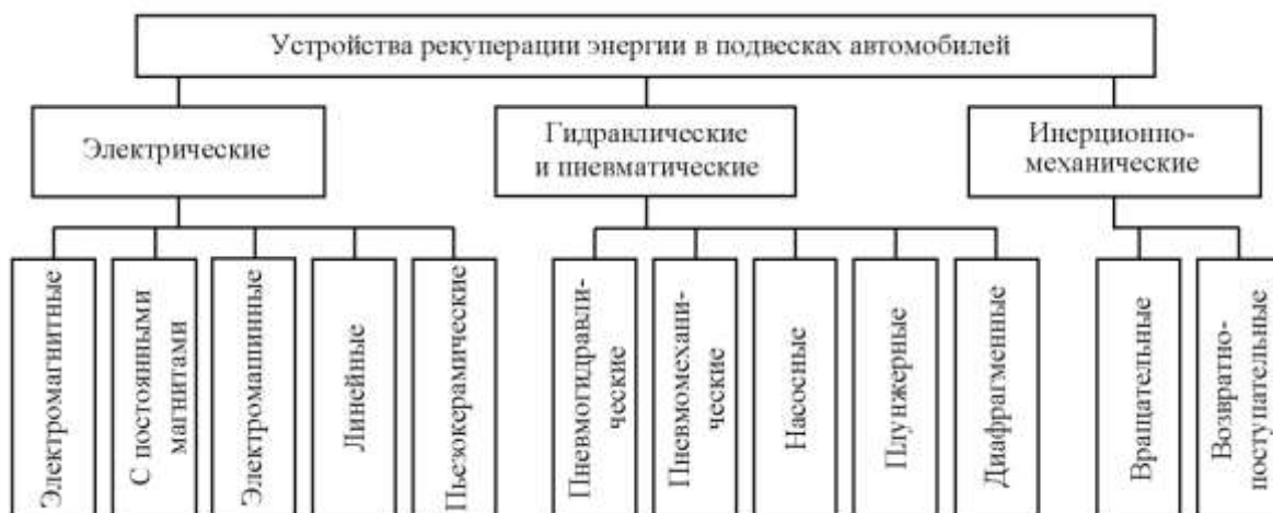
Рисунок 1 – Классификация механизмов рекуперации энергии используемых в подвесках колесных машин
