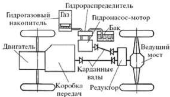
Рисунок 10 – Схема автомобиля с системой рекуперации энергии торможения
