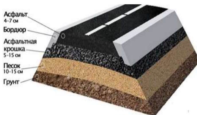
Рисунок 1 – Разрез дороги с традиционным покрытием
