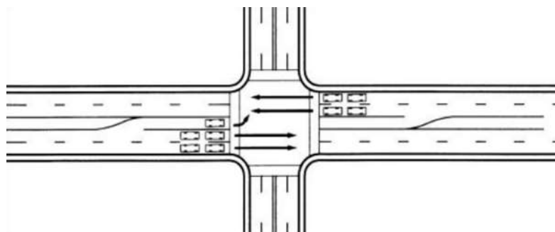
Рисунок 6 – Выделенные полосы для левых поворотов – отсутствие блокирования движения в прямом направлении ТС, поворачивающими налево
