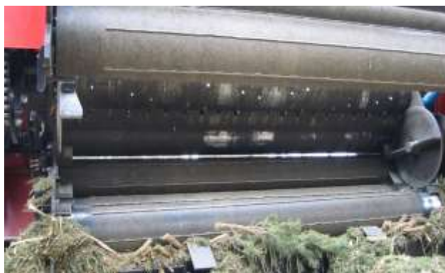
Рисунок 5 – Продольная прессовочная камера с верхней загрузкой материала пакетирующего Valmet WoodPac
