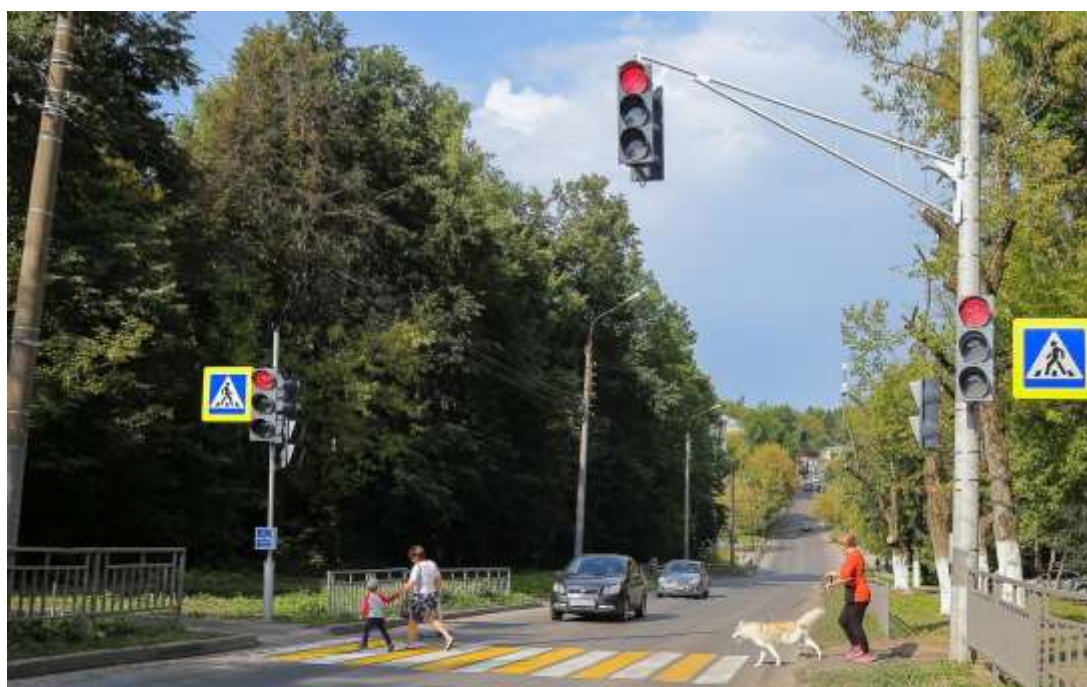
Рисунок 2 – Пример светофора типа 1
