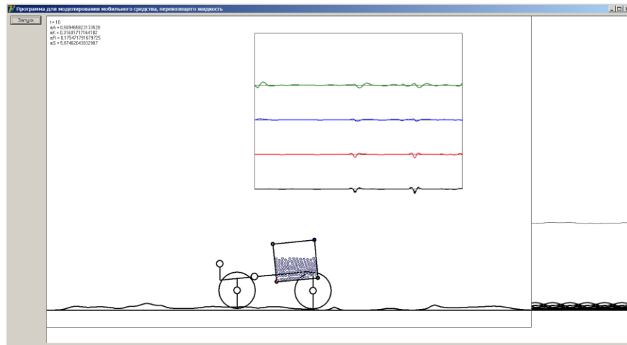
Рисунок 2 – Вывод результатов моделирования в «Программе для моделирования движения мобильного средства, перевозящего жидкость в баке»
