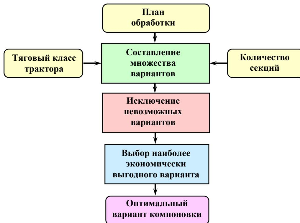
Рисунок 1 – Схема поиска оптимальных вариантов компоновки МТА модульными почвообрабатывающими орудиями
