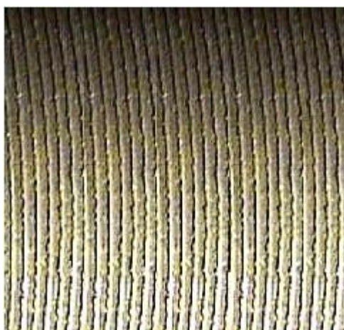
Рисунок 4 – Макроструктура покрытия полученного ПН+ЭМО из материала ПГСР-4 при скорости вращения образца 0,03 м/с и продольной подачи плазматрона 0,1 мм/об.
