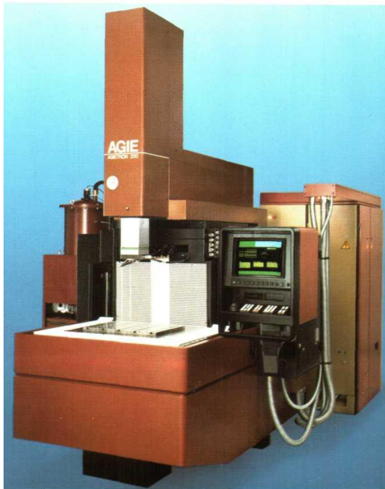
Рисунок 4 – Установка для разделения материалов проволочным электродом
