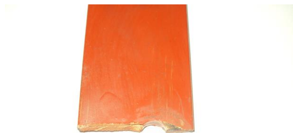
Рисунок 4 – Излом токоведущей шины в месте крепления к изолятору
