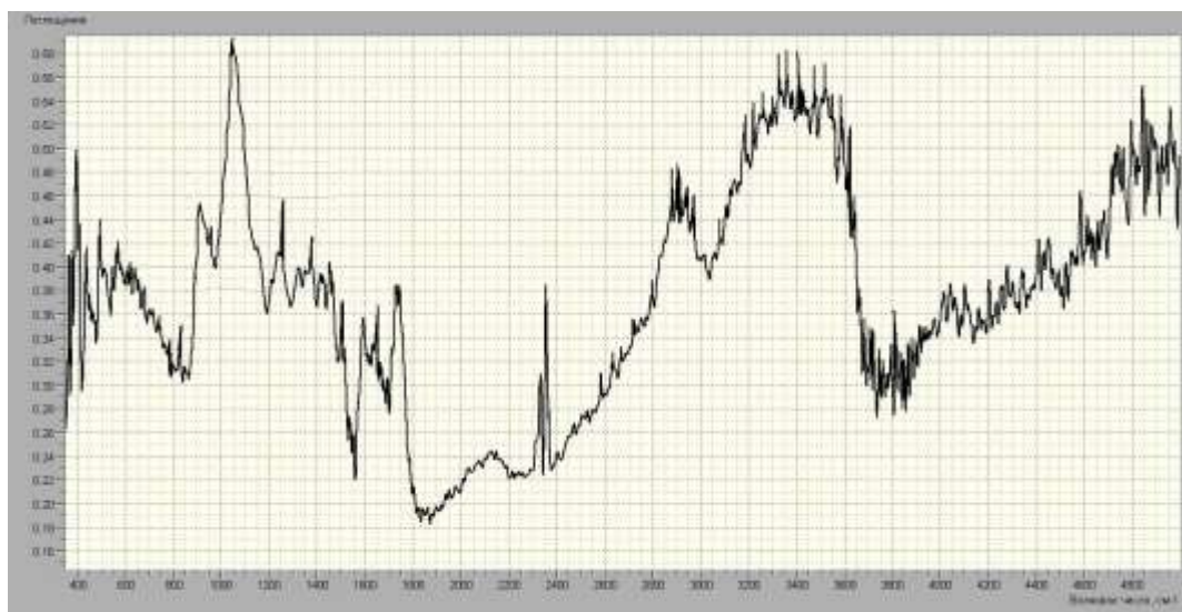
Рисунок 5 – ИК-спектры древесины березы, модифицированной глиоксалем после выдержки в воде
