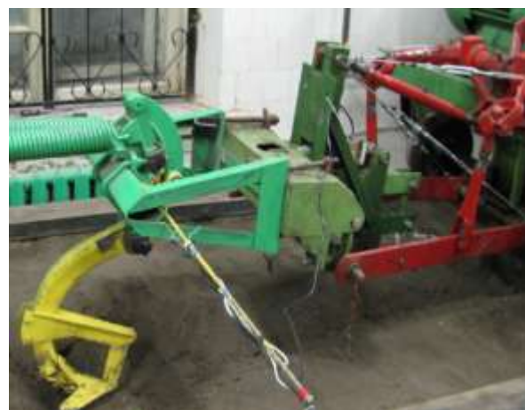
Рисунок 5 – Тензометрическая навеска конструкции ВГЛТУ
