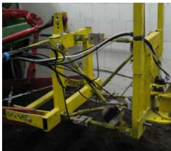
Рисунок 11 – Установка для объемного тензометрирования с шестью S-образными датчиками нагрузки
