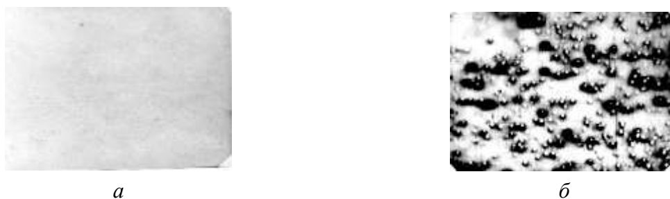
Рисунок –7 Оптическое (а) и акустическое (б) изображения приповерхностных слоев образца пьезокомпозиата ПВХ с ЦТС-23 ( Z = -17 мкм, H_2O , 407 МГц, масштаб 40 мкм/дел.)
