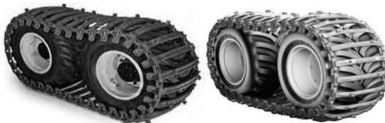
Рисунок 2 – Металлическая гусеница двухосного колесного движителя
